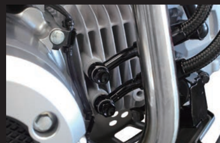
装着写真(オイル取り出し口)
