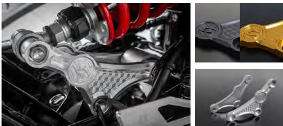
ビレット・ハニカムサスペンションリンクプレートは、スタンダードのリンク比を基準に乗り心地の変化を抑えた設計で約20mmローダウンにするサスペンションリンクプレート。荷重が分散するよう全周にわたりアール形状を描くプレート本体は、13mm厚のジュラルミン材を採用し軽量ながら高い剛性を確保しています。緻密に刻み込まれたハニカムデザインと大胆にあらわれた立体的なARCHIロゴは強烈な存在感を放ち、リア廻りのドレスアップにも効果的です。※ステンレスアジャスタブルサイドスタンド(品番:189-5051) or ショートサイドスタンド(品番:189-5031)との同時装着を推奨します。
