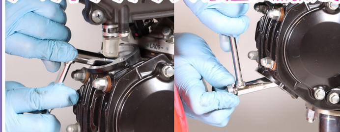
グロム、モンキー 125系エンジンのタペットクリアランス調整や、点検をする為の工具です。シックスネスゲージと併せてご使用ください。
