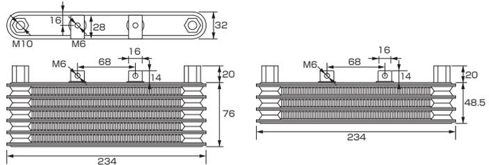
ボアアップをはじめとして、ハイチューンされたエンジンの必需品。高回転・高性能化したエンジンはその代償として膨大な熱を発生し、ノーマルのままでは、オーバーヒート・焼き付き等、破損する場合がありますので、オイルクーラーの装着をお薦めします。ニュースーパーオイルクーラーは400ccクラスのオイルクーラーと同等の放熱量(5段コア)を誇り、レースを始め炎天下等の苛酷な条件下でも、安定したエンジン性能を発揮します。
