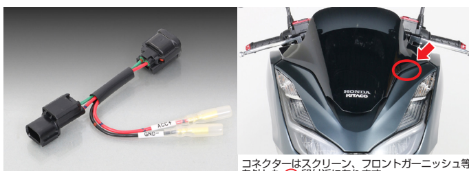
コネクタはスクリーン、フロントガーニッシュ等を外した○印付近にあります。
