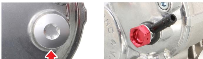
ブローバイガス取出し用ボルト (M10-P1.25) を外すのにトルクスレンチが必要です。
