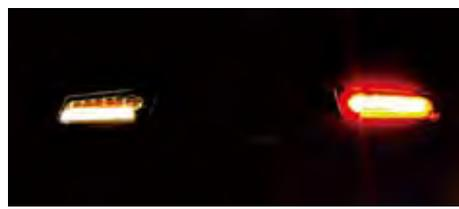
②ウインカー作動時はウインカー(上側)が点灯。ポジション灯(下側)は消灯。反対側はポジション灯が点灯状態。
