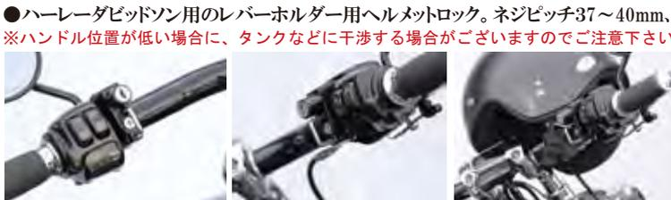
●ハーレーダビッドソン用のレバーホルダー用ヘルメットロック。ネジピッチ37~40mm、1/4インチボルトに対応。左右兼用タイプ。
