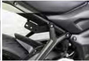
●トライアンフがミドル市場に提案するコンパクトなトライデント660。コンパクトな車体のため日本の市場には必需品のETCを取める場所がないことが悩みの種です。ハンドル周りをすっきり見せるためにも一体型ではなく、別体型の装着を考えている方も多いと思います。そこでトライデント660用のETCケースステーが登場！当社K3ブランドのタクティカルETCケースや革のケースの取付もできるように考えました。センター穴もあるので他のポーチも取付可能です。左右どちらでも装着可能。
