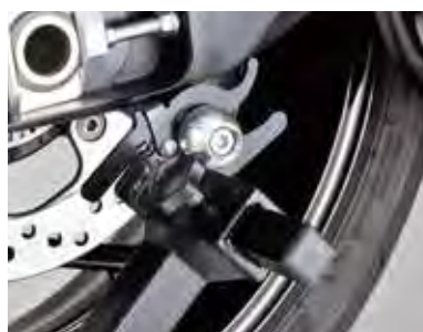
バネクランプ機構付きのアタッチメントでスプールの沿ってスタンドが脱落しません。
