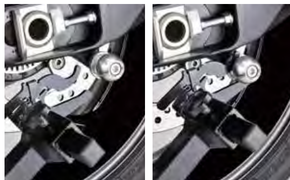
スプールの沿ってバネが広がるため、差し込むだけでセットできます。
