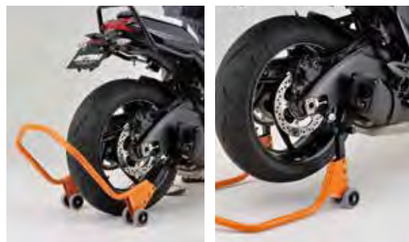
車体が傾いている状態からスプールのセットされ続けるため、外れやすい状況を回避します。
