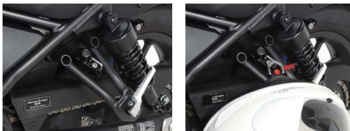
タンデムステップ共締めタイプのヘルメットロック ツーリング、出先の休憩等の短時間ヘルメットを掛けておくのに便利です。
