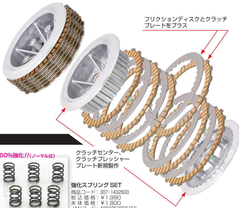
ノーマルのクラッチ(5枚)に対し6枚に変更することにより、クラッチ容量がアップします。
