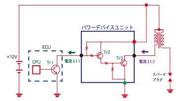
※ スーパーIGコイル単体での使用はECU破損の原因となる場合があります。 必ず専用パワーデバイスと併用願います。
