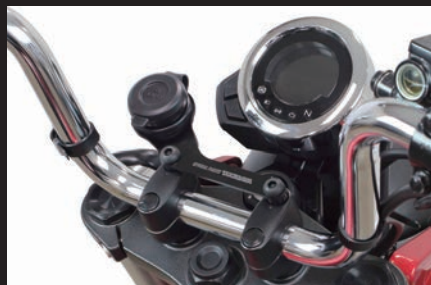
ダックス125 (JB04) にシガーソケットステー 別売純正アクセサリースOCKET同時装着
