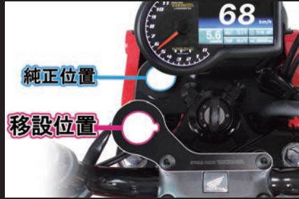
純正アクセサリースOCKET取付け部(純正位置)と SP武川製シガーソケットステー取付け部(移設位置)
