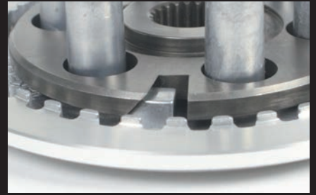
スリッパークラッチ作動状態イメージ
