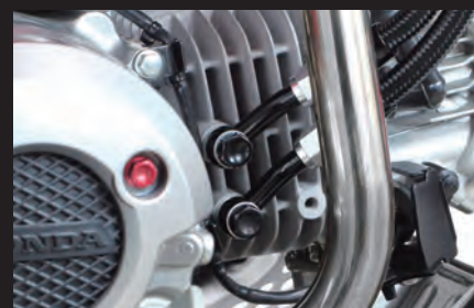
装着写真(オイル取り出し口)
